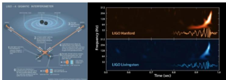
Slika 4.2: Ilustracija aparature koja detektuje gravitacione talase i prvi detektovani signal u istoriji.
